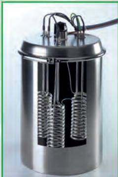
U cilindru od nerđajućeg čelika kvaliteta od 1 do 5, grejni elementi takođe od nerđajućeg čelika greju vodu po principu uronjenih grejača. Opremljen je prekidačem sa plovkom i mehaničkim senzorom pregrevanja koji kontrolisu nivo vode i obezbeđuju zaštitu od suvog rada.
