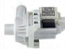
Pumpa za odmuljavanje velikog kapaciteta objedinjuje kombinovan rad sistema ispiranja i odstranjivanja kamenca odvođenjem taloga kamenca. Čestice se odstranjuju pre taloženja, što smanjuje količinu kamenca u filtru i produžava vreme između dva servisiranja.
